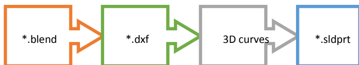
Фиг. 7.6. Процес на трансфер на геометрични данни от Blender в CAD системата SolidWorks
