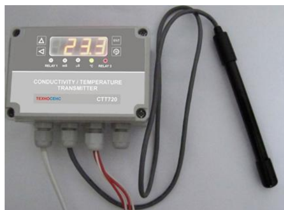
Фиг. 76. Проектиран кондуктометър
