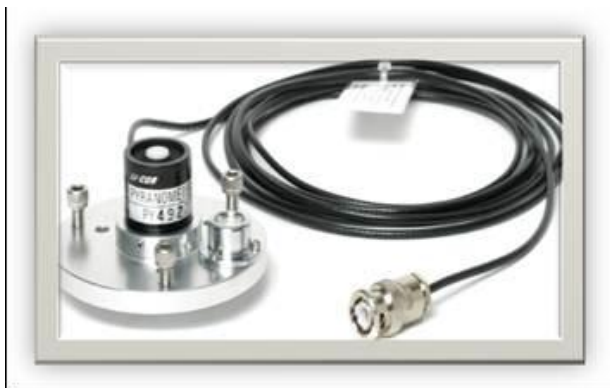
Фиг.3.5. Пиранометър тип LI-COR200
