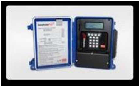
Фиг. 3.15. Data logger Symphonie PLUS на фирма NRG
