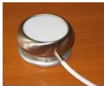
Фиг.3.11. Чувствителен елемент тип DIY подобрен модел с термична компенсация
