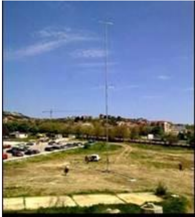
Фиг.4.2. Метеорологична мачта на територията на ТУ-Варна за измерване параметри на Слънцето и вятъра
